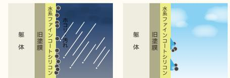
親水性塗膜なので汚れが付着しても雨水で徐々に流され、高レベルの低汚染性を発揮します。
